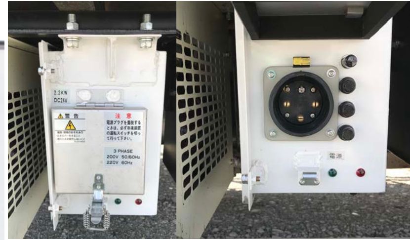
スタンバイ機能 設定温度 -30^{\circ}\text{C} \sim 25^{\circ}\text{C}
